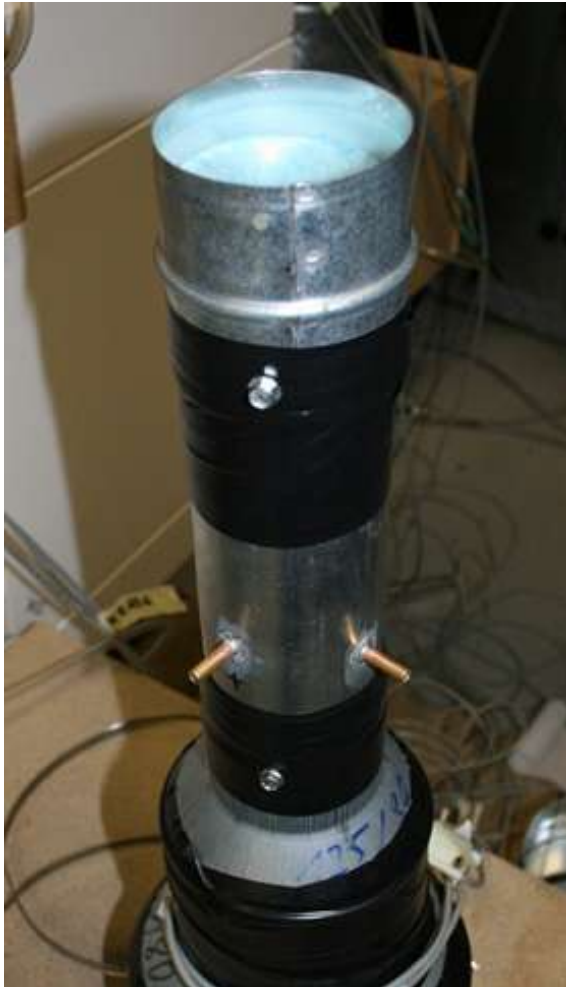
Abbildung 13: Volumenstrommessung Sekundärluft mit V-Control Filtermatte (hellblau) im Rohr zur Homogenisierung der Strömung.
