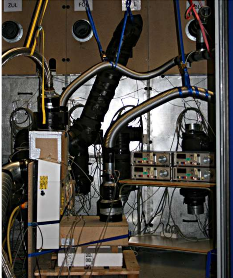
Abbildung 1: Prüfling AKLKK-900 eingebaut in den Prüfstand für Kompaktlüftungsgeräte Prükom.
