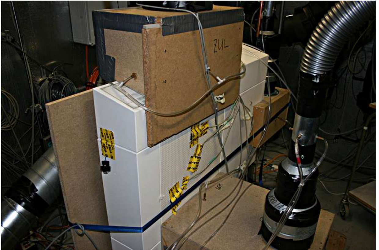
Abbildung 12: Anschlussboxen Sekundärluft (unten) und Zuluft (oben)
