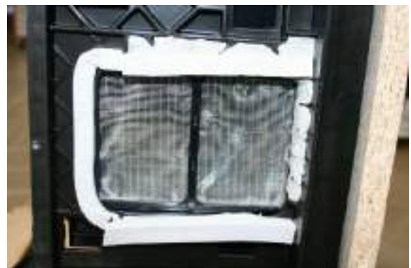
Abbildung 15: Abdichtung am Ablufteintritt für unverfälschte Volumenstrommessung (Kein Qualitätsmangel vom AKLKK-900).
