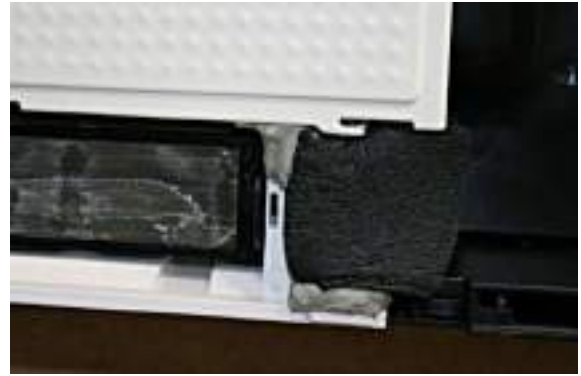
Abbildung 14: Abdichtung am Sekundärlufteintritt für unverfälschte Volumenstrommessung (Kein Qualitätsmangel vom AKLKK-900).
